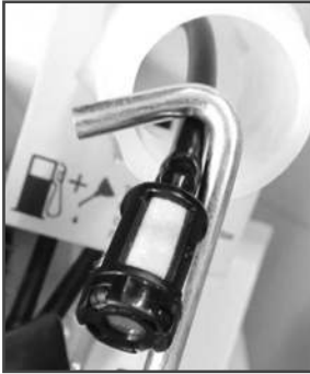
Рис.10 Извлечение топливного фильтра
